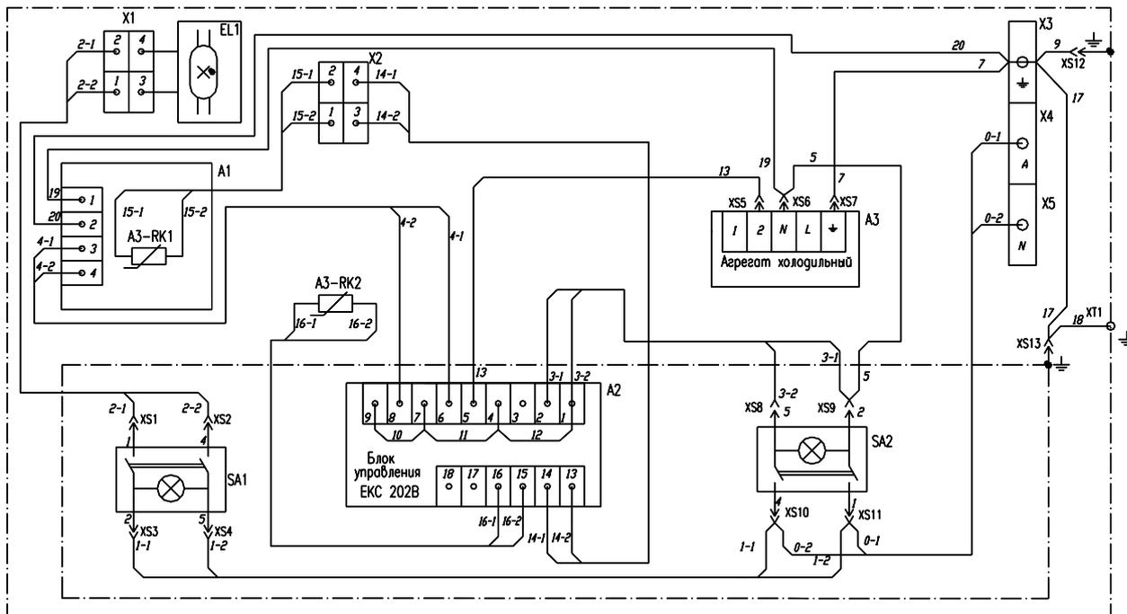
Номера входных и выходных выводов на агрегате холодильном А3, воздухоохладителе А1, колодках клемных X1, X2, выключателях SA1, SA2, присвоены условно.
